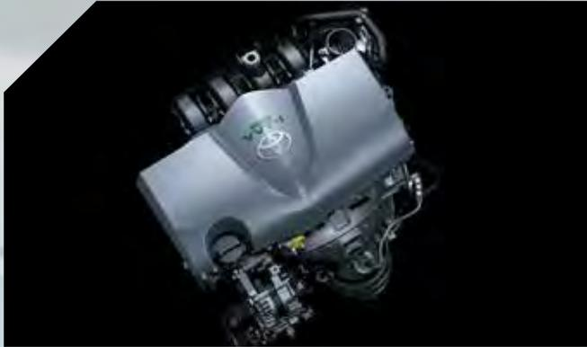
Motor 1.5 lt, 16 válvulas con sistema Dual VVT-i.
